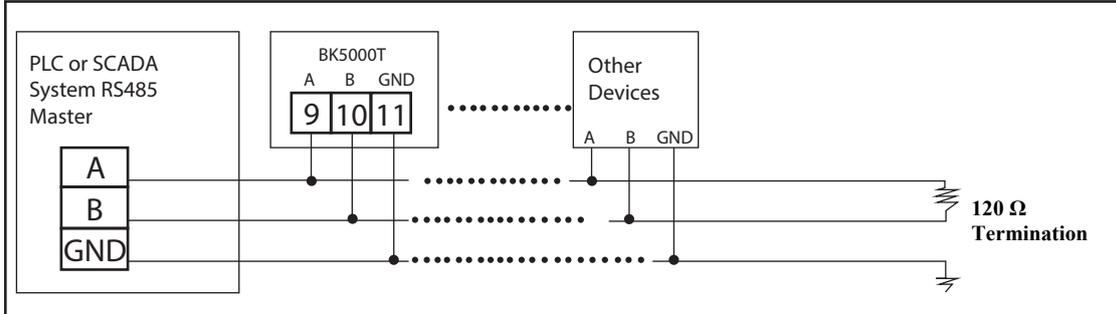
**Figure 43 : RS 485 / Modbus Half Duplex Circuit**
